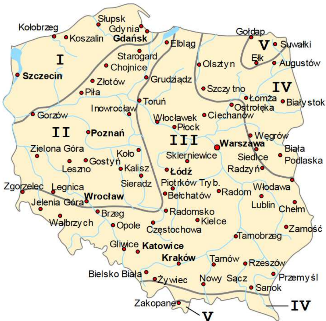
Rysunek 9: Podział terytorium Polski na strefy klimatyczne. Źródło: M. Strzeszewski, P. Wereszczyński, Metoda obliczania obciążenia cieplnego budynków wg normy PN-EN 12831, Warszawa 2016, s. 7.
